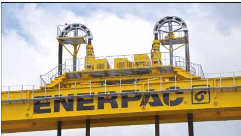
◀ Система тросовых домкратов HSL85007 в разработанном на заказ самомонтируемом порталном кране Enerpac.
