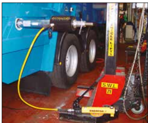
◀ RACH-306 с ручным насосом Р-392 используется для извлечения закорродированных осей из мусороборочной машины.
